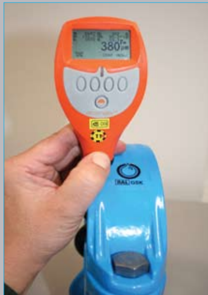
správná tloušťka navrstvení je více než 250 \mu\text{m}
