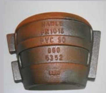
nekvalitní příprava dílu - zbytky koroze
