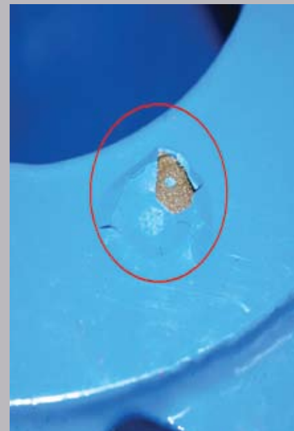
vrstva neodolala zkoušce rázem - odlupuje se
