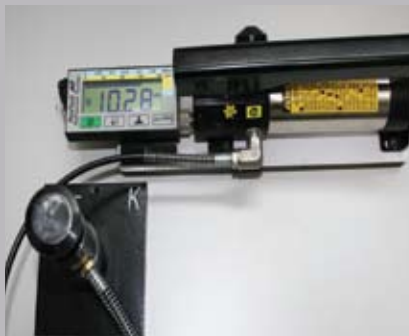
přilnavost je nižší než 12N/mm 2 - nevyhovuje
