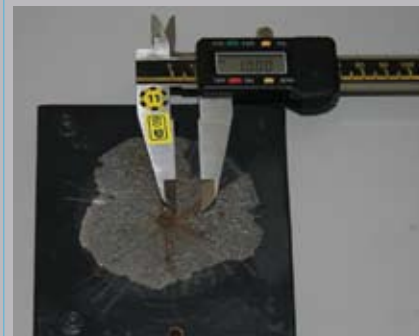
migrace koroze je více než 10 mm - nevyhovuje
