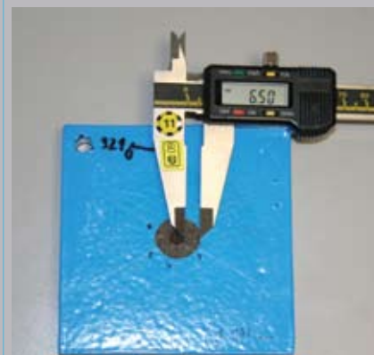
migrace koroze je méně než 10 mm - vyhovuje
